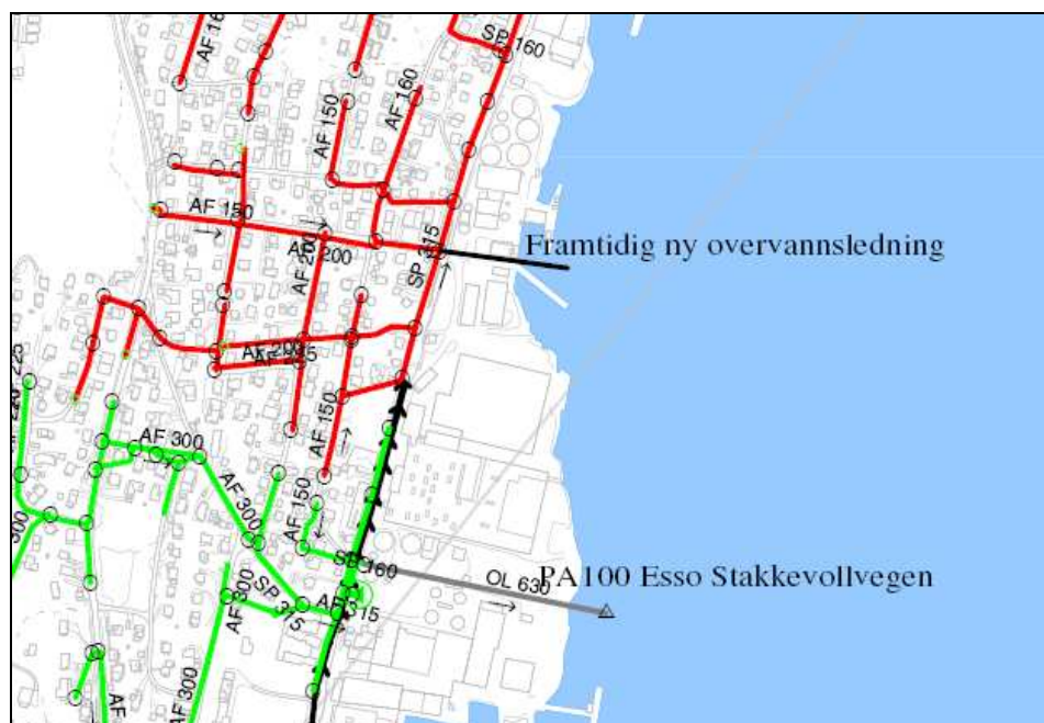
Behov for ny overvannsledning i Terjevika
